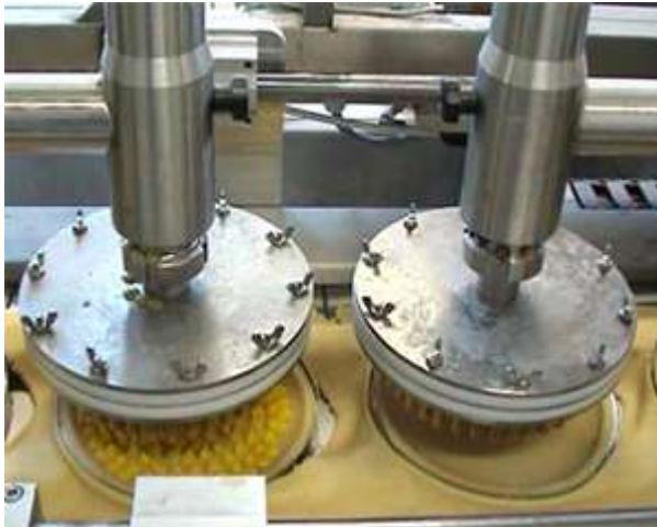
**ЭЛЕКТРОПНЕВМАТИЧЕСКИЕ ДОЗАТОРЫ ДЛЯ ДОЗИРОВКИ ПОЛУГУСТЫХ, КРЕМООБРАЗНЫХ И ЖИДКИХ ТЕСТОВ И НАЧИНOK (БИСКВИТА, КРЕМА, МАРМЕЛАДА И Т.Д.) 1шт.**
