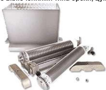
Насосная (шестеренчатая) головка предназначена для отсадки жидких бисквитов, джемов, кремов. Имеет вращение шестеренок в обратную сторону (от друг друга).
