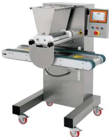
**Отсадочная машина MINIDROP PRO** - это компактная и многофункциональная машина для производства печенья и кондитерских изделий.
