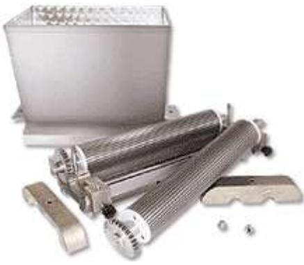
**Валковая головка для кантуччи с уменьшенным диаметром валов. Предназначена для отсадки теста с включениями типа орехи, цукаты.**
