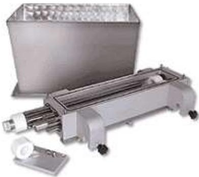
**Силиконовая подогревающая рубашка для бункера, для работы с продуктами требующими подогрев во время работы (зефир, жировые крема и т.д.) Терморегулятор позволяет выставить температуру от 30 до 90 градусов. Требуется установки специального бункера с вертикальными стенками.**
