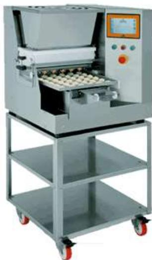
Самая маленькая из представленных на рынке отсадочно-дозировочных машин для производства кондитерских изделий новая модель **BABYDROP MAXX** фирмы MIMAC предназначена для работы с противнями шириной 400 или 450 мм. С выпуском этой модели машины технологии отсадки кондитерских изделий стали доступными и для предприятий общественного питания. Большой выбор насадок позволяет создавать изделия самых разнообразных форм и размеров.
